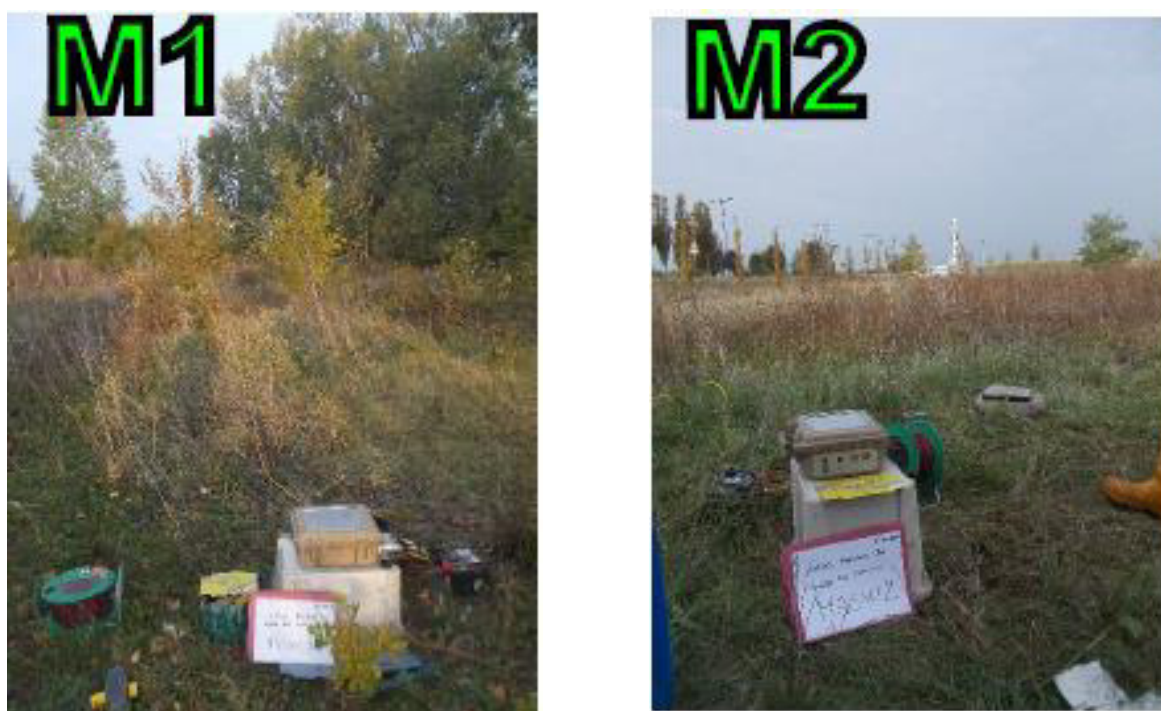
Fig. 5 Prova Sismica superficiale tipo MSW
