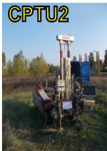
Fig. 6 Prova Penetrometrica Statica di tipo CPTU
