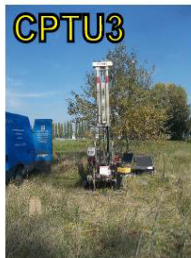
Fig. 6 Prova Penetrometrica Statica di tipo CPTU
